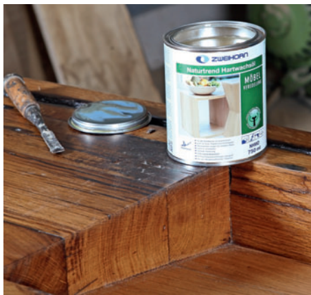
/ Im nächsten Arbeitsschritt trägt er das Naturtrend-Hartwachsöl NHWO auf. Dieser Arbeitsgang ...
