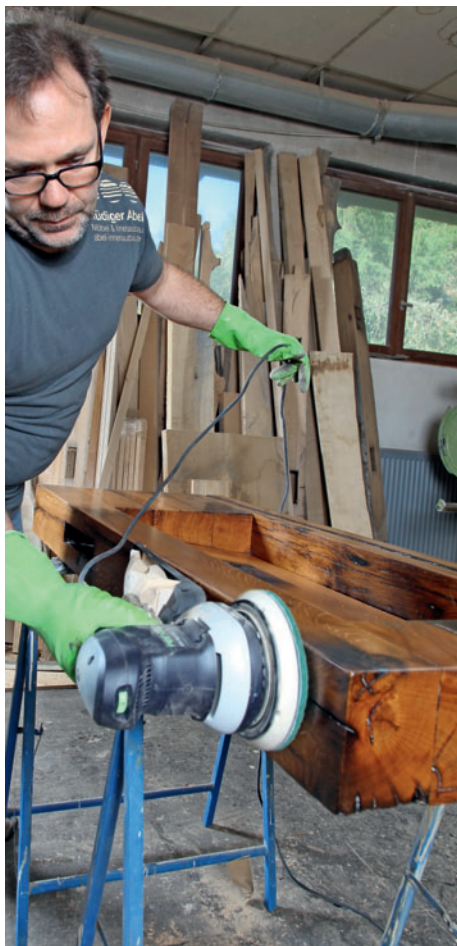
/ Mit dem Exzentrerschleifer wird das Hartwachsöl jeweils noch „einmassiert“.
