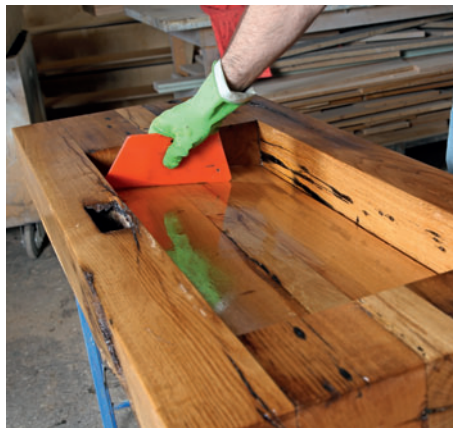
/ Nach der Einwirkzeit wird das überschüssige Öl mit der Rake, dann mit einem Lappen abgenommen.
