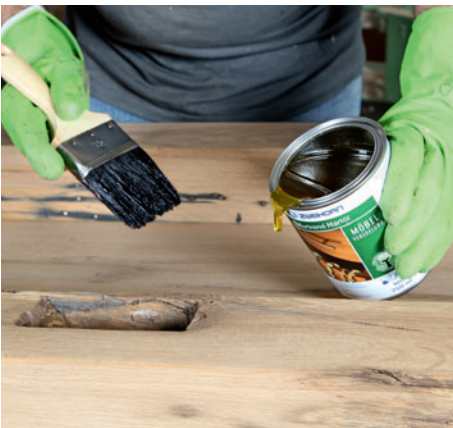
/ Im ersten Arbeitsschritt der Oberflächenveredelung trägt Rüdiger Abel das Naturtrend-Hartöl auf.
