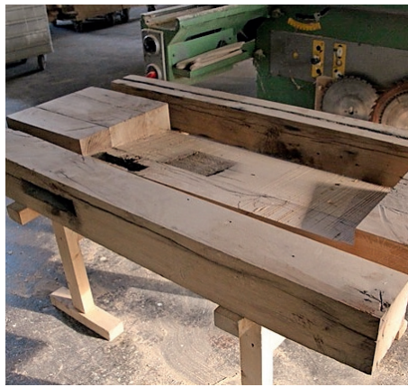
/ Die einzelnen Balkensegmente werden vor dem Verleimen grob in Form gebracht.
